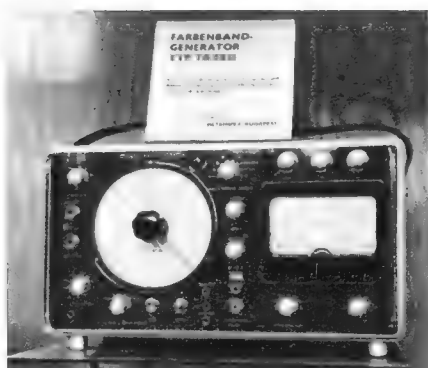
Bild 4. Farbbalkengenerator für den Farbfernseh-service (NTSC-Norm) Modell TR-0816 (Metrim-pex, Budapest)
