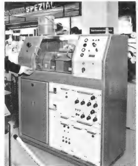
Bild 3. Schleifautomat zum Einschleifen von Wendeln in Widerstandskörper mit einer Taktzeit von einer bis fünf Sekunden (VEB Elektromat, Dresden)
